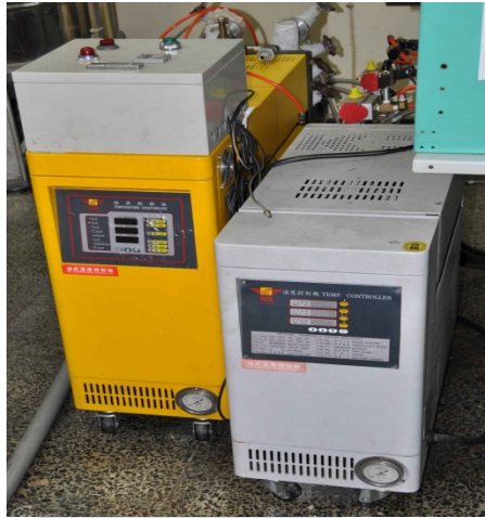
圖 4 - 3 高低模溫機變模溫系統
