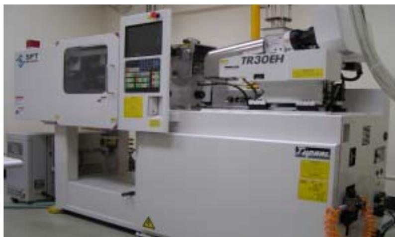
圖 46 精密射出成型機
