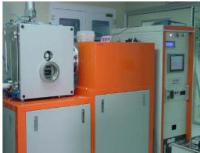
圖 40 電子束蒸鍍機
