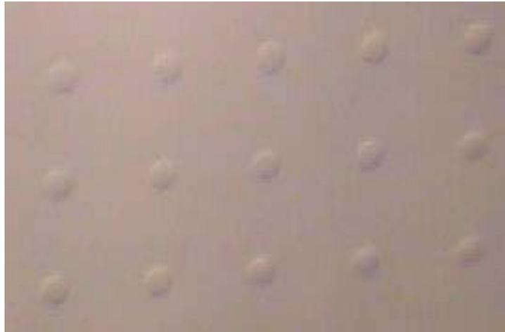
圖 108 PMMA 微結構之 30um
