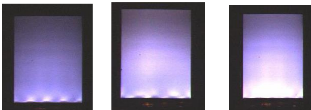
(a)非最佳條件(射出成型) (b)最佳條件(射出成型) (c)最佳條件(射出壓縮成型)
