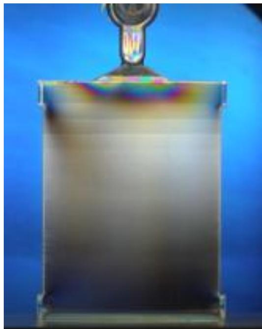
圖 5-6 射出成型導光板光彈應力圖
