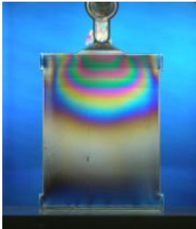
圖 5-4 射出成型導光板光彈應力圖
