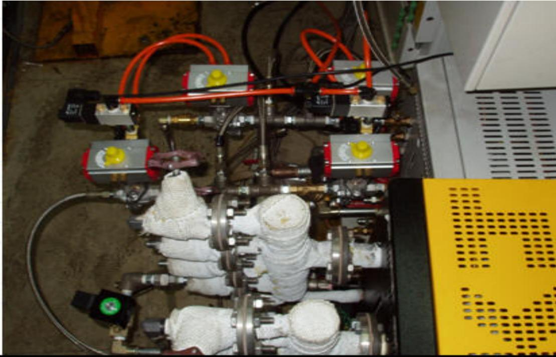
圖 4-8 模溫機與氣動控制閥
