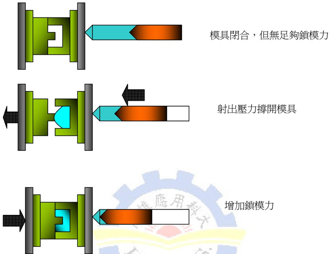
圖 3-3 鎖模力的切換
