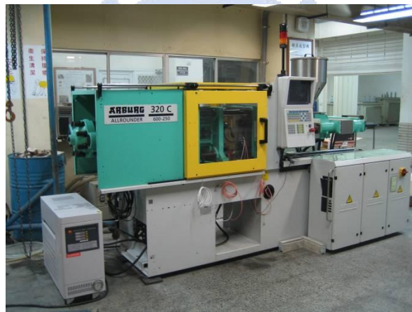
圖 4-4 ARBURG All Rounder 320C 射出成形機
