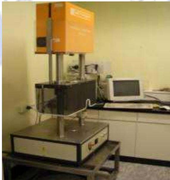
圖 4-4 毛細管流變儀
